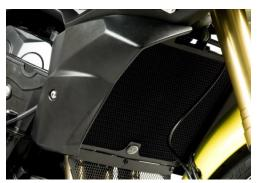
Dieser Kit beinhaltet: 1x Kühlerschutz (RAD0187) 1 x Kabelbinder 4x 100mm Schaumstoffstreifen
